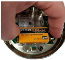
3. À l'avant du coffre-fort, installez une nouvelle pile de 9 volts dans chacun des deux supports de piles du clavier. Les piles de marque Duracell® sont recommandées. Soutenez le haut de chaque support avec un pouce ou un doigt lorsque chaque pile est insérée. Cela aidera à éviter de plier ou de casser les montants du support.
