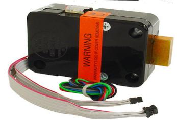
**Vis de fixation :** Utilisez uniquement les vis fournies avec la serrure. Les vis de montage du corps de serrure seront de ¼-20 ou M6, selon l'application. Ils doivent engager la plaque de montage par au moins quatre filetages complets. N'utilisez pas de rondelles de blocage ou de composés d'étanchéité pour filetage sauf indication contraire dans les instructions d'installation complètes.
