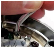
5. Placez le clavier sur la base. Assurez-vous que le câble du clavier est dégagé des deux attaches à ressort du coussin lorsque vous poussez fermement le clavier sur la base. Il devrait se mettre en place. Si vous devez retirer le clavier, tirez d'abord le bas (zone la plus proche du logo S&G) loin de la base de montage. Ne laissez jamais le clavier pendre par le câble connecté.
